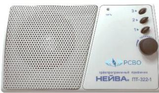
Воспроизводит три программы сети проводного вещания. Световой индикатор включения приемника, регулятор громкости и кнопки переключения программ находятся на лицевой панели прибора. Выключатель расположен на верхней крышке приемника. Регуляторы чувствительности 2-й и 3-й программы расположены на задней панели прибора.
